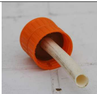
As tampas coladas uma contra a outra e a mangueirinha atravessando-as. Este lado mais comprido da mangueirinha é o que irá do lado do reservatório inferior.
