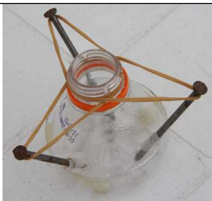
Reservatório inferior com pregos mantendo os canudinhos na posição para serem colados.
